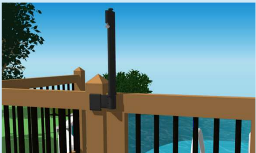
Exemple de loquet pouvant être installé du côté extérieur de l'enceinte, même lorsque celle-ci mesure moins de 1,5 m de haut.
