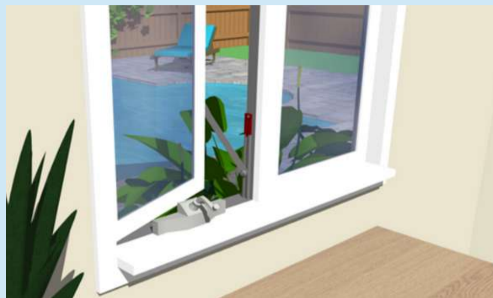
Limiteur d'ouverture pour fenêtre
