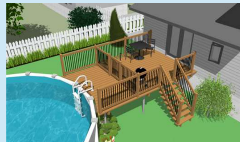
Exemple de terrasse rattachant la piscine à la résidence. La partie ouvrant sur la piscine est adéquatement protégée par une enceinte.
